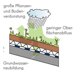
Gründächer halten, je nach Bauart, 50 - 90 % der Niederschläge zurück. Ein Großteil dieses Wassers verdunstet, der Rest fließt zeitverzögert ab. Rohrleitungen, Kanäle, Überlaufbecken etc. können so kleiner dimensioniert werden.
